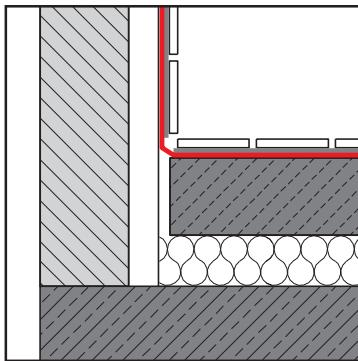
Pastaraisiais dešimtmečiais vis plačiau yra naudojamas hidroizoliacijos kaip sudėtinės konstrukcijos su plytelėmis ir plokštėmis įrengimo būdas. Šis metodas, pirmą kartą pradėtas taikyti 1987 m., paplito kaip placiai naudojama ir labai patvari hidroizoliacijos sistema, pagrįsta realia praktika ir norminiais aktais.
